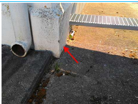
Matériaux : ZPSO-002 Prélèvement : P003 Description : Enduit extérieur soubassement Localisation : Bat 50 - Facade Résultat : Absence d'amiante
